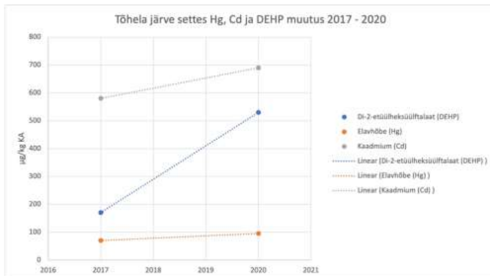
Joonis 6. Tõhela järve settes DEHP, kaadmiumi ja elavhõbeda sisalduste muutus 2017 - 2020
